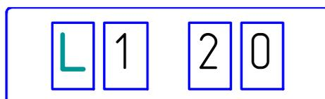
Рис.4.7 - Индикация времени непрерывной работы подогревателя. (установленное время работы подогревателя составляет 1ч 20 минут).
